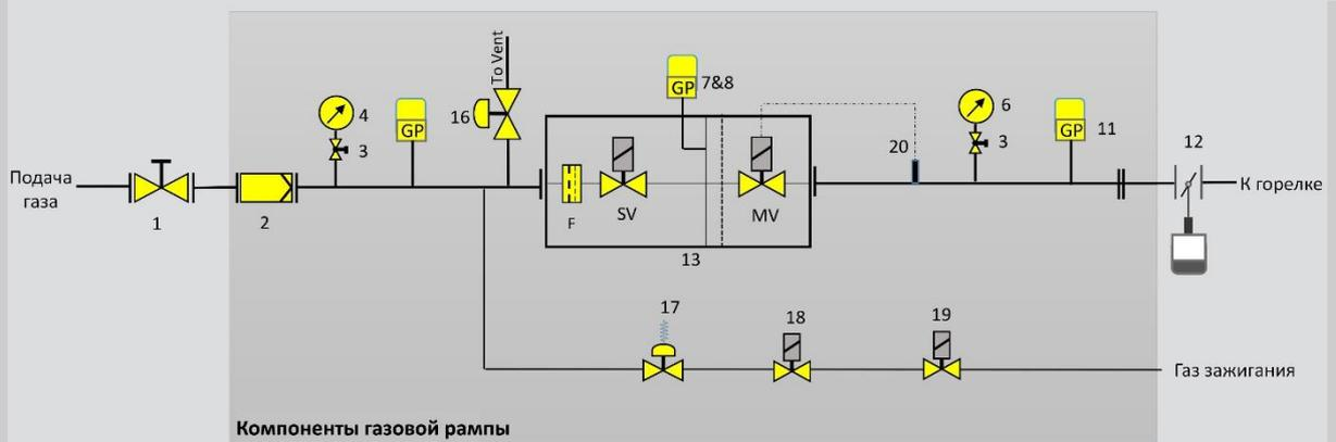
**GT3** (входное давление >360 мбар, отдельные элементы, газ зажигания (с пилотом))
