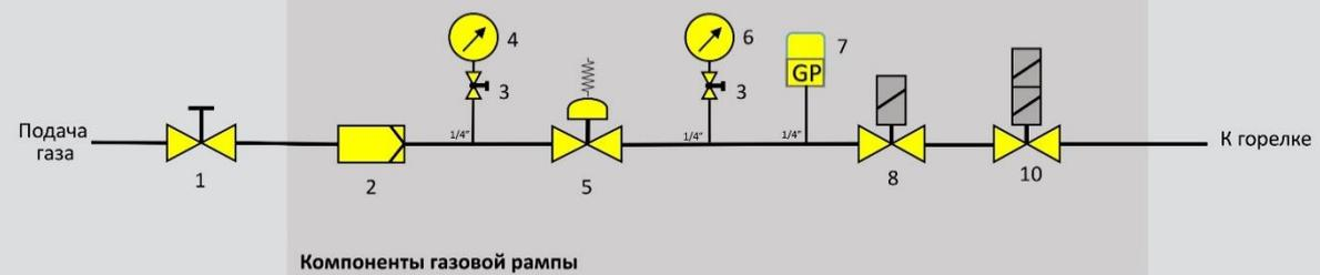
**GT3** (входное давление <360 мбар, отдельные элементы, двухступенчатая с системой проверки герметичности клапана)
