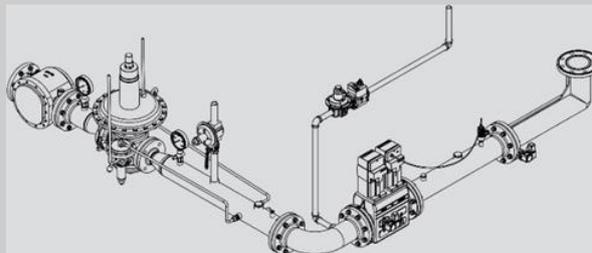
**Подача газа низкого давления.** Входное давление < 360 бар общая потеря давления в газовых клапанах, газовом дросселе и камере сгорания не превышает 200 мбар.
