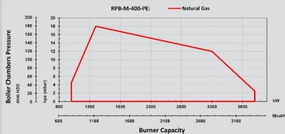
Рабочий диапазон мощности для газовой горелки сертифицирован в соответствии с BS-EN 676.
