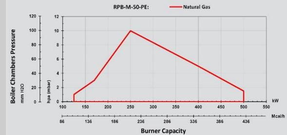
Горелка РPB-M-50/PE Мощность (кВт) NG:125-500 Степень модуляции 1:4
