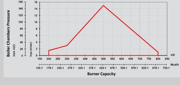
Горелка РPB-M-125/PE Мощность (кВт) NG:300-1200 Степень модуляции 1:4
