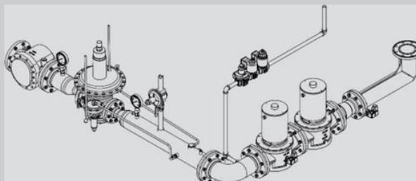
**Подача газа высокого давления версия с мультиблоком.** Используется, когда входное давление составляет от 360 мбар до 4 бар. Общая потеря давления в газовых клапанах, газовом дросселе и камере сгорания не превышает 450 мбар.
