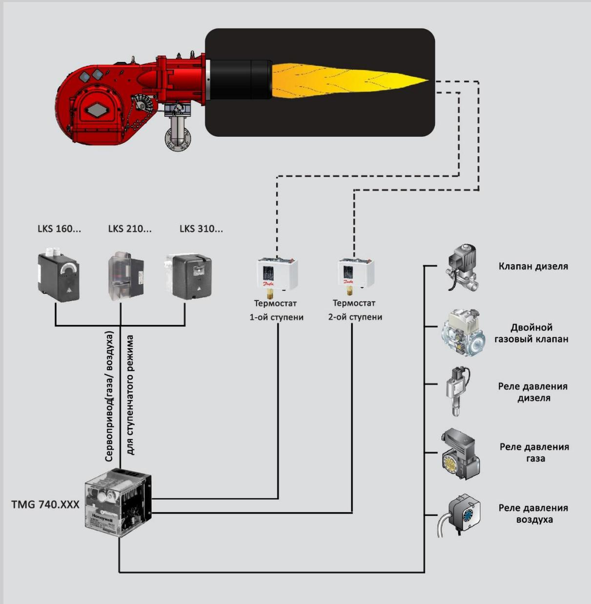
Два термостата и двухступенчатый привод предназначаются для ступенчатых горелок серии RGB-MS.
