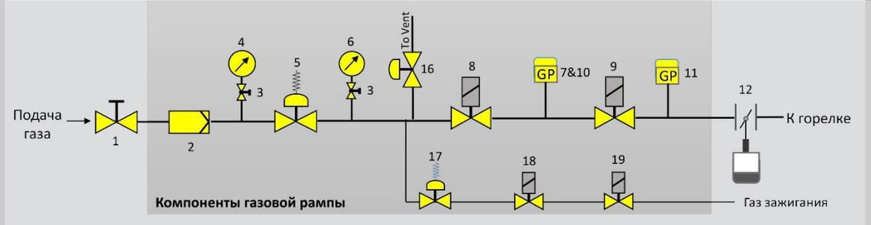
**GT2** (Входное давление <360 мбар, комплектация с мультиблоком, газ зажигания (с пилотом))
