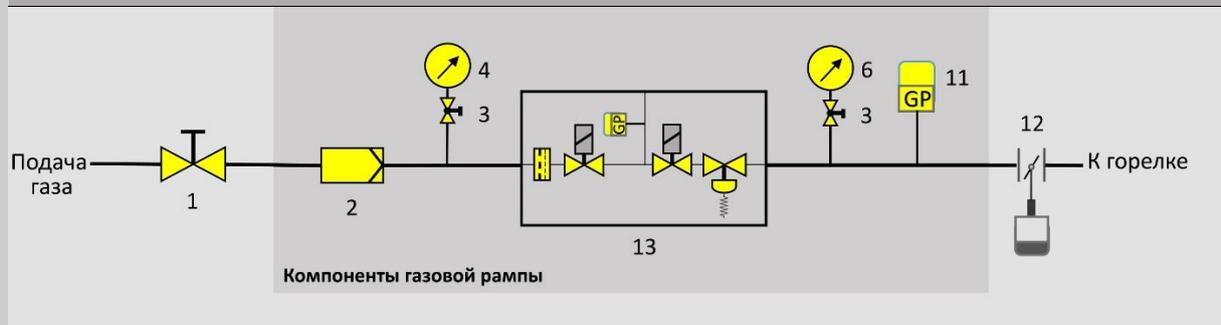
**GT3** (Входное давление <360 мбар, отдельные элементы, газ зажигания (с пилотом))
