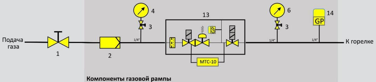
**GT6** (Входное давление <360 мбар, отдельные элементы, с системой проверки герметичности клапана)
