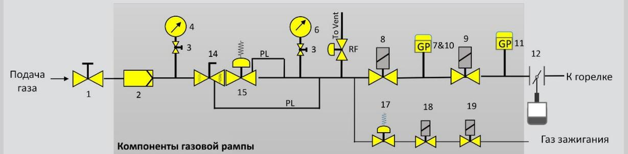
**GT4** (Входное давление <360 мбар, комплектация с мультиблоком, газ зажигания (с пилотом))
