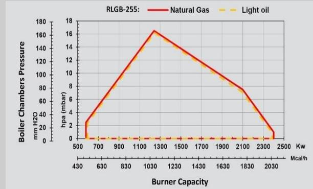
Рабочая схема для газовой горелки сертифицирована в соответствии с EN 676.
