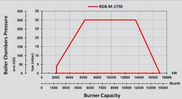
Коэффициент модуляции 1:8, 1:9, 1:10 и т.д. доступен для горелки с сервоприводом пламенной головы (опция). В стандартном исполнении коэффициент модуляции составляет 1:6.
