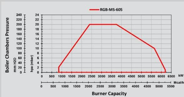
Рабочая схема для газовой горелки сертифицирована в соответствии с EN 676.
