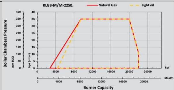
\* Коэффициент модуляции 1:8, 1:9, 1:10 и т.д. доступен для горелки с сервоприводом пламенной головы (опция). В стандартном исполнении коэффициент модуляции составляет 1:6.
