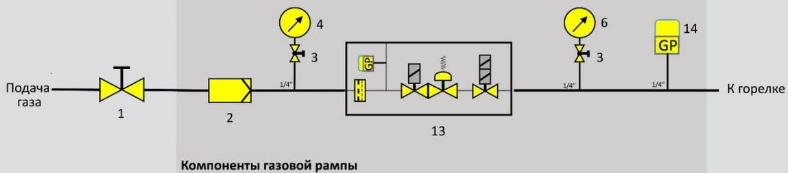
**GT5** (входное давление <360 мбар, многоблочные элементы, с системой проверки герметичности клапана)
