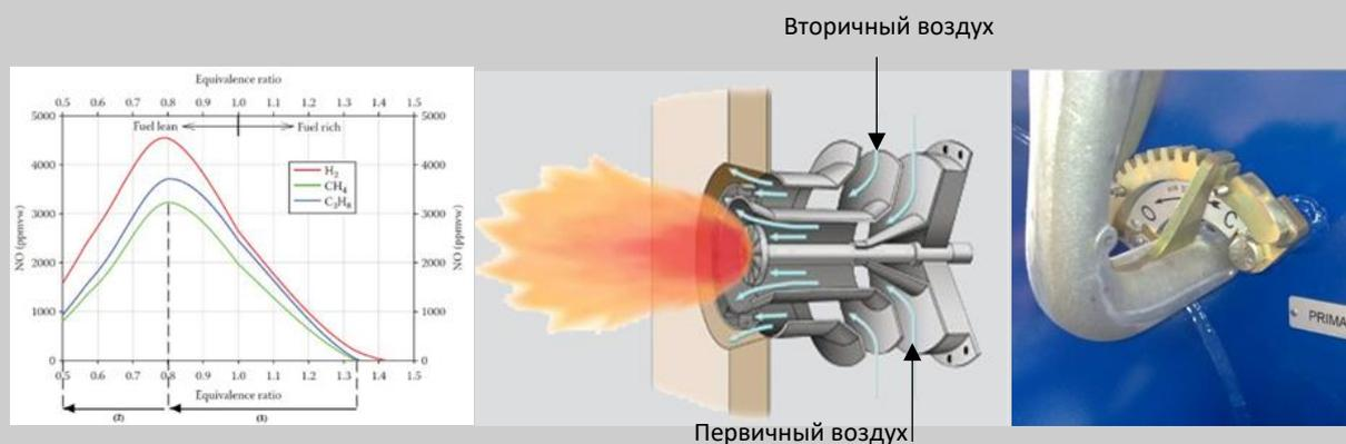
Горелки Raadman WT оснащены двумя воздушными регистрами, подходящими для любого вида жидкого и/или газообразного топлива, с возможностью одновременного сжигания одного или нескольких видов топлива. Воздух для горения разделяется на «первичный» и «вторичный» потоки, в результате чего горение происходит послойно.
