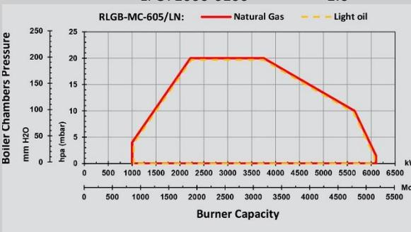
Рабочий диапазон для газовой горелки сертифицирован в соответствии с EN 676 И BS EN 267.
