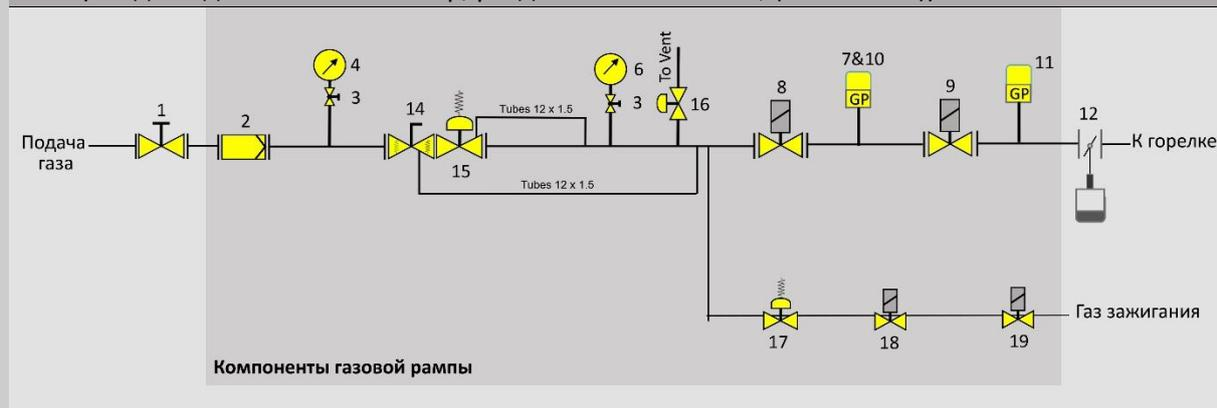
**GT5** (Входное давление >360 мбар, комплектация с мультиблоком, газ зажигания (пилотом))
