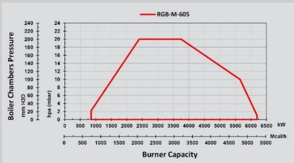
Рабочие диапазоны мощности газовых горелок сертифицированы в соответствии с BS-EN 676.
