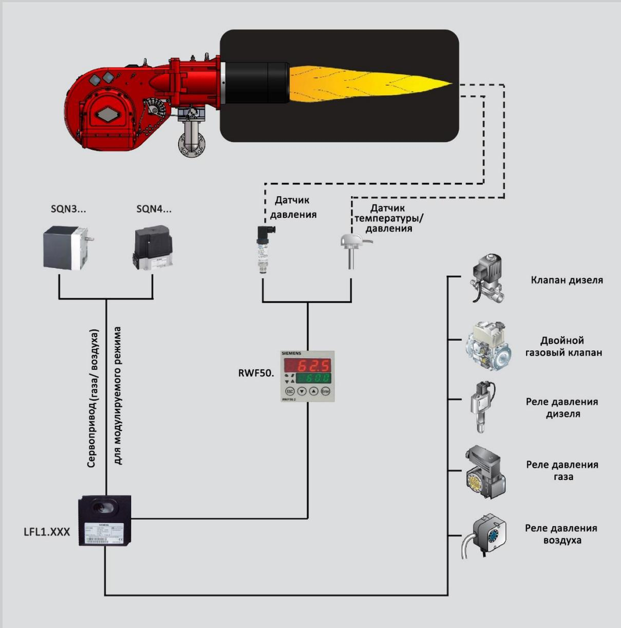
Горелки RGB-MS требуются регулятор с трехточечным управлением на выходе. В следующем списке перечислены компоненты, необходимые для механического модулируемого регулирования.
