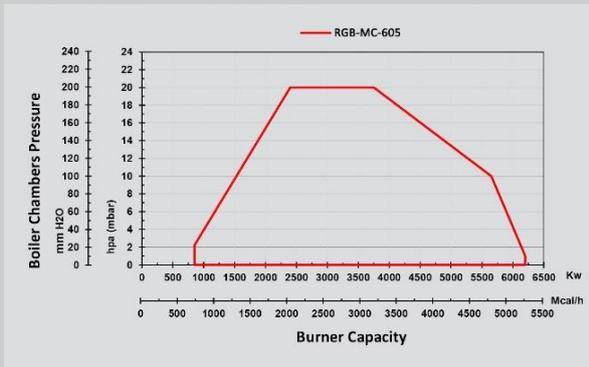
Рабочая схема для газовой горелки сертифицирована в соответствии с EN 676.
