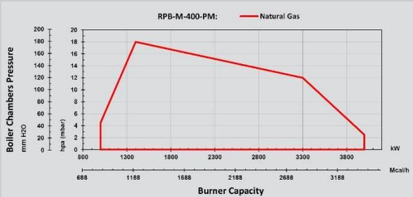
Рабочие диапазон для газовой горелки сертифицирована в соответствии с BS-EN 676.
