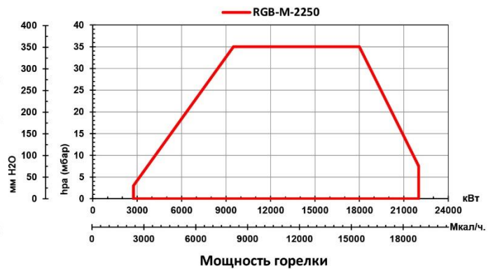
Давление в камере сгорания котла
