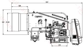
• Рекомендуемый диаметр фланца крепления к котлу = 492 мм
