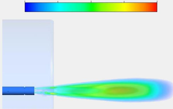
للحصول على معدل انخفاض الضغط لكل من الهواء والغاز، وأنماط تدفق و درجة الحرارة داخل المحرقة و حجرة الاحتراق، و شكل اللهب، و معدل انبعاث ملوثات الهواء. في هذه المرحلة، يمكن اكتشاف تصادم اللهب مع بعضها البعض، و من ثم يمكن تعديل ترتيب المحركات بطريقة تمنع حدوث التصادم.
